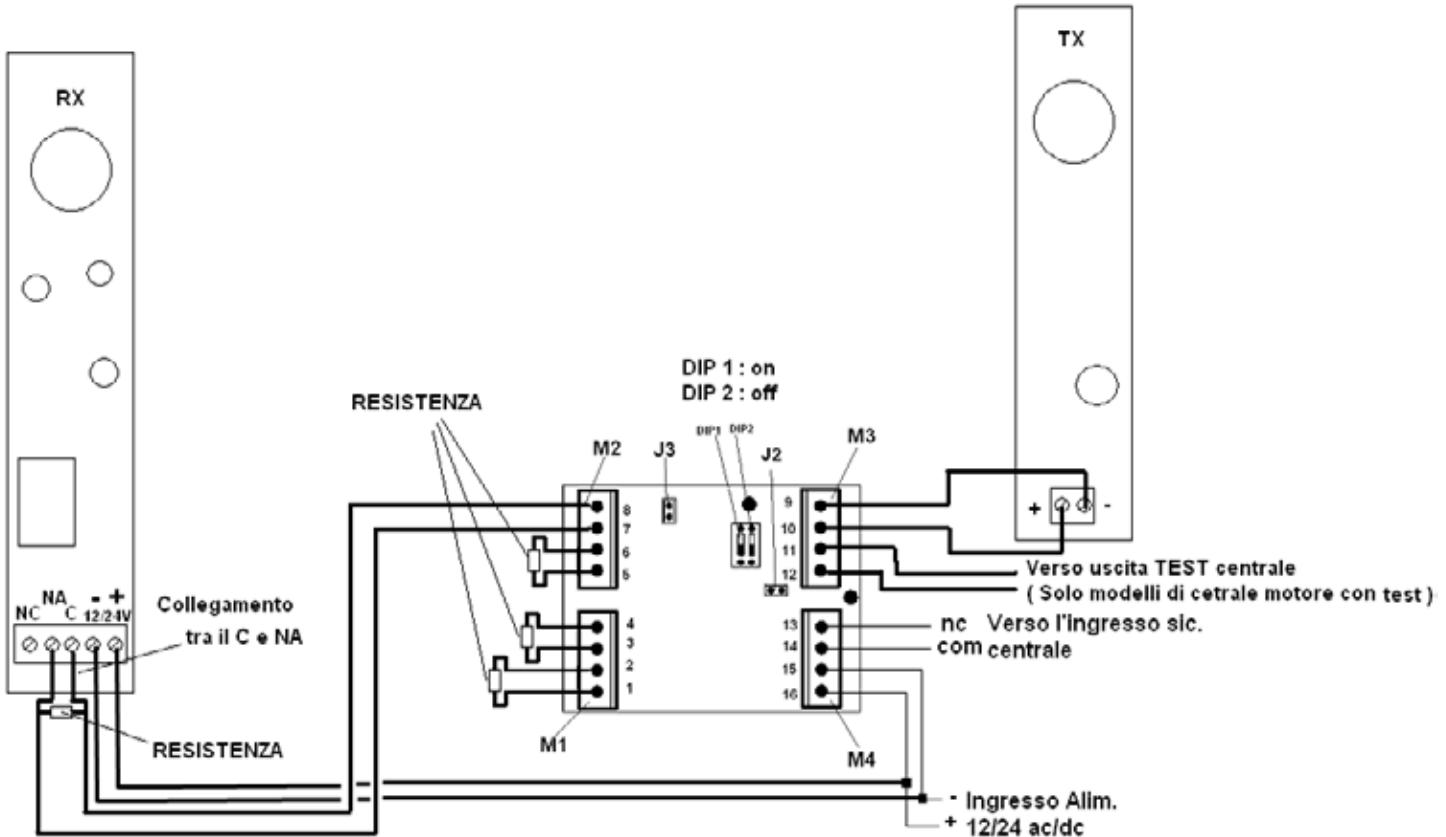
ATTENZIONE : I JUMPER RELATIVI ALLA TENSIONE DI ALIMENTAZIONE DEL DISPOSITIVO NO TOUCH DEVONO ESSERE INSERITI O NON INSERITI IN BASE ALLA TENSIONE DI ALIMENTAZIONE DEL NO TOUCH E DELLA SA04PLUS
