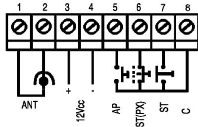
**Attention:** l'entrée PX doit être N.C. s'il est configuré comme entrée photocellule ou STOP.
