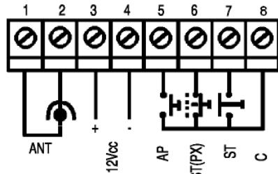
**Der konfigurierbare Eingang muss N.C. (negative Logik) sein, wenn er als Stop oder Fotozelle programmiert wird.**
